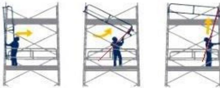
**CONCEPTION DE MONTAGE Pose des Garde-Corps avec perches pliables**
